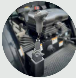
Joystick incorporado para pala cargadora
